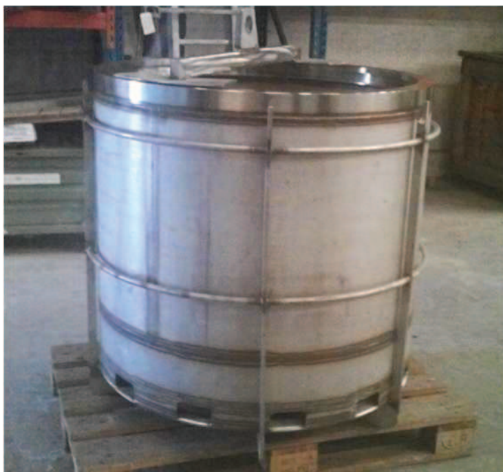
Figure 2.g : Panier métallique accueillant les déchets bloqués
